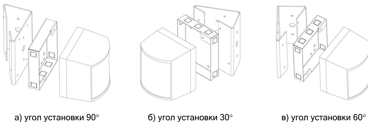
Рисунок 3 - Варианты установки извещателя на кронштейне с использованием базового основания
